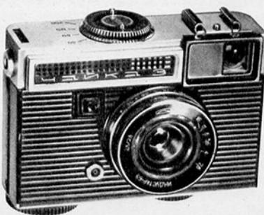
автоматических выдержек от 1/30 до 1/250 сек. Выдержки «B» (от руки) в фотоаппарате «Чайка-3» нет, что упростило конструкцию фотоаппарата и его сборку. Затвор состоит из двух основных узлов: узла лепестков и рычага, открывающего затвор, совмещенного с механизмом перемотки пленки и блокировкой затвора от двойной экспозиции. Имеется гнездо для подключения электронной лампы-вспышки с X-синхронизацией.
